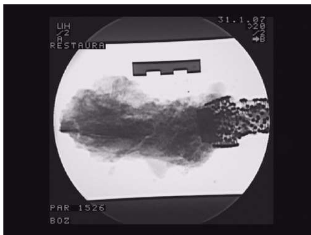
Röntgenafbeeldingen van het lemmet en het heft voor restauratie
