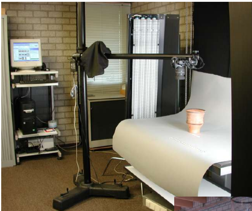
Foto-installatie waarbij de afbeeldingen meteen digitaal worden opgeslagen
