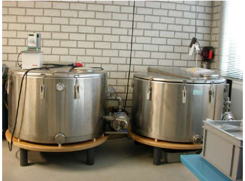
De ontzoutingsinstallatie voor het behandelen van ijzeren voorwerpen
